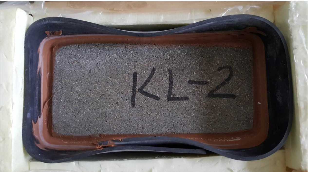
4 Joonis Betoonplokk KL-2 enne külmutus-sulatuskatset (ülal) ja pärast 72 katsepäeva (all)
