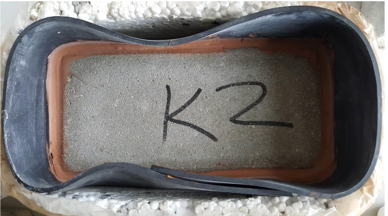
8 Joonis Betoonplokk K2 enne külmutus-sulatuskatset (ülal) ja pärast 72 katsepäeva (all)
