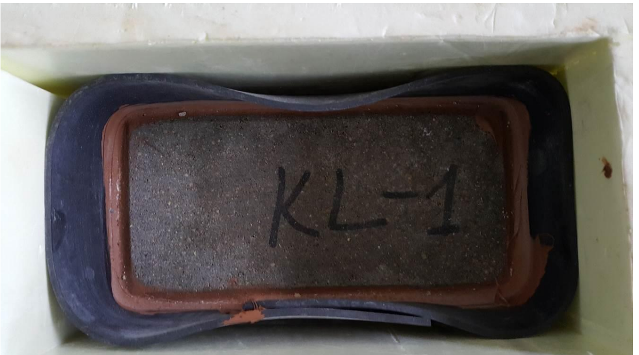
3 Joonis Betoonplokk KL-1 enne külmutus-sulatuskatset (ülal) ja pärast 72 katsepäeva (all)
