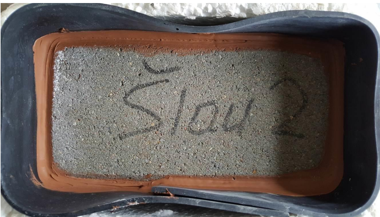
6 Joonis Betoonplokk Šiau2 enne külmutus-sulatuskatset (ülal) ja pärast 72 katsepäeva (all)
