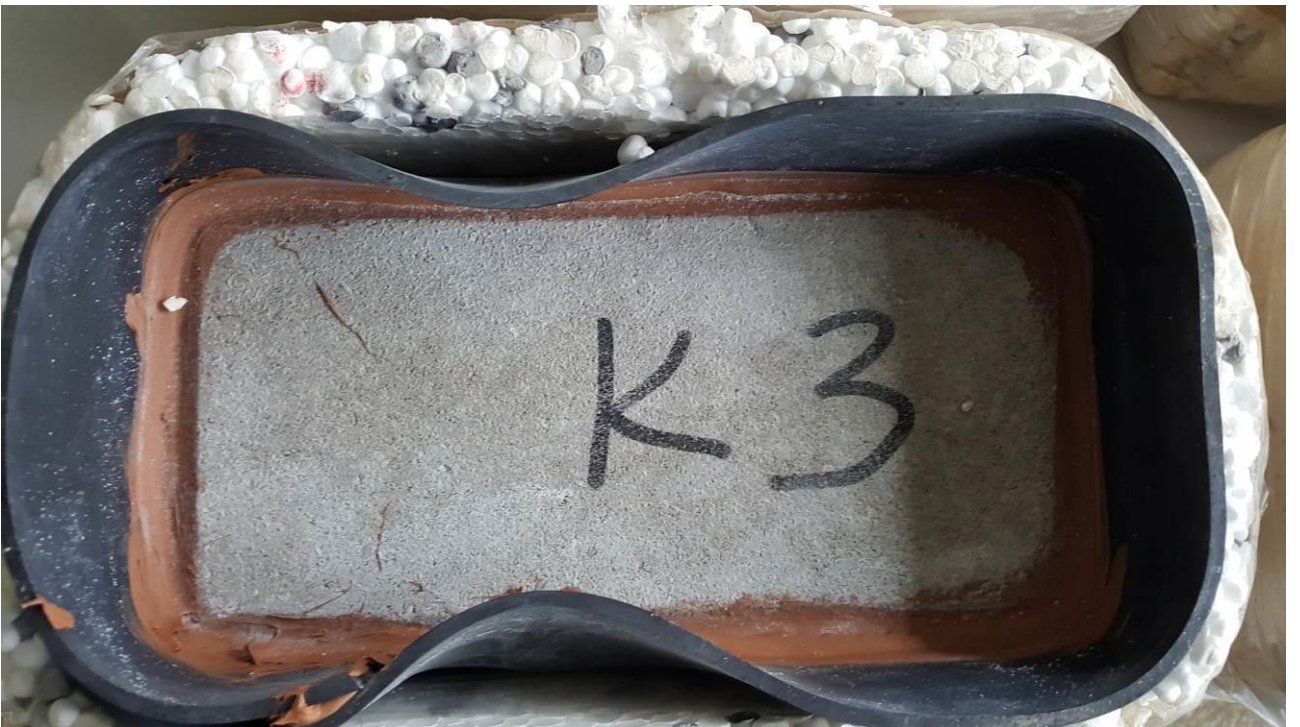
9 Joonis Betoonplokk K3 enne külmutus-sulatuskatset (ülal) ja pärast 72 katsepäeva (all)
