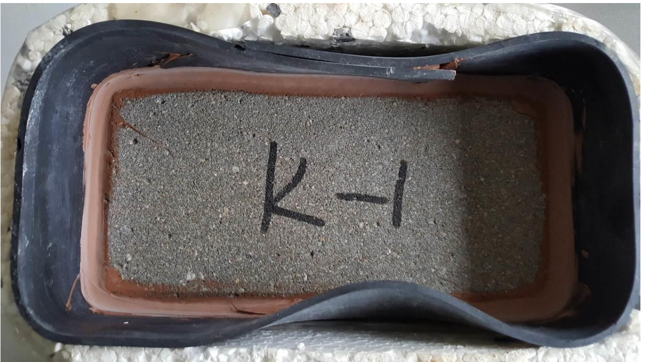
7 Joonis Betoonplokk K-1 enne külmutus-sulatuskatset (ülal) ja pärast 72 katsepäeva (all)
