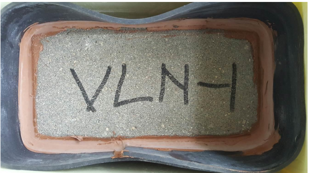
1 Joonis Betoonplokk VLN-1 enne külmutus-sulatuskatset (ülal) ja pärast 72 katsepäeva (all)
