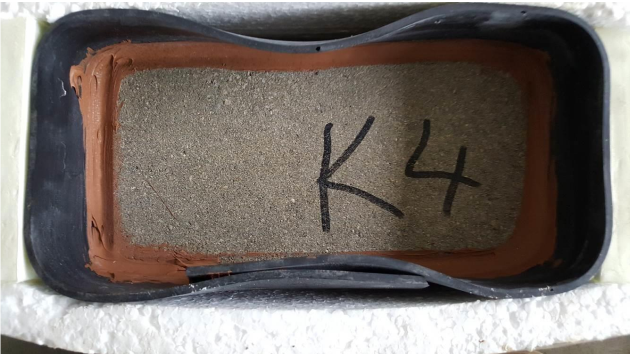
10 Joonis Betoonplokk K4 enne külmutus-sulatuskatset (ülal) ja pärast 72 katsepäeva (all)
