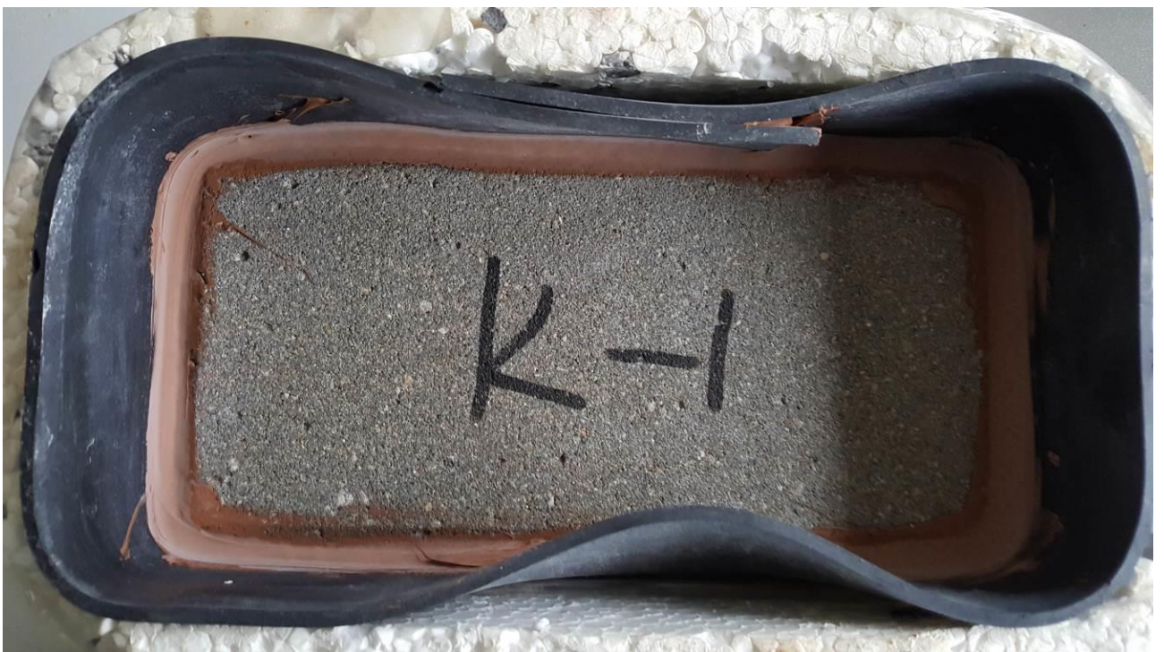
7 pav. K-1 trinkelė prieš šaldymo bandymą (viršuje) ir po 72 parų bandymo (apačioje)
