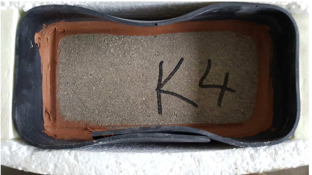
10 pav. K4 trinkelė prieš šaldymo bandymą (viršuje) ir po 72 parų bandymo (apačioje)
