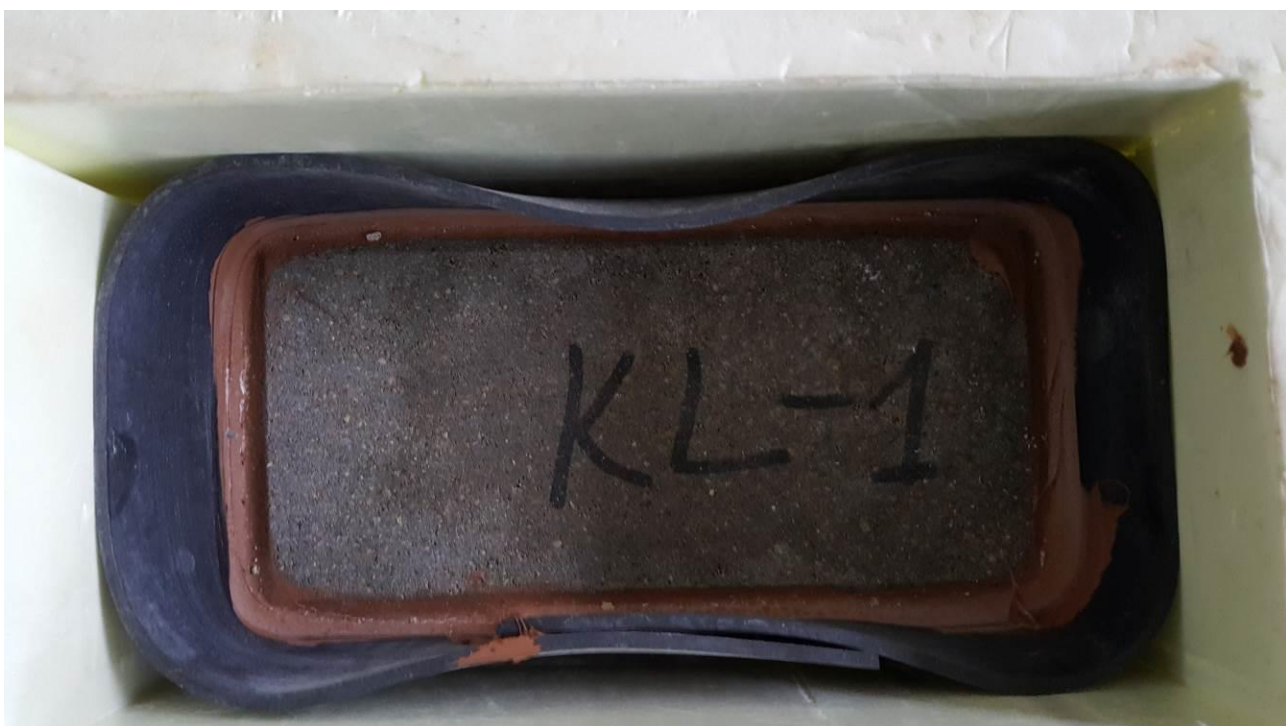
3 pav. KL-1 trinkelė prieš šaldymo bandymą (viršuje) ir po 72 parų bandymo (apačioje)
