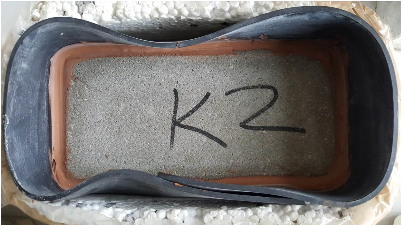
8 pav. K2 trinkelė prieš šaldymo bandymą (viršuje) ir po 72 parų bandymo (apačioje)
