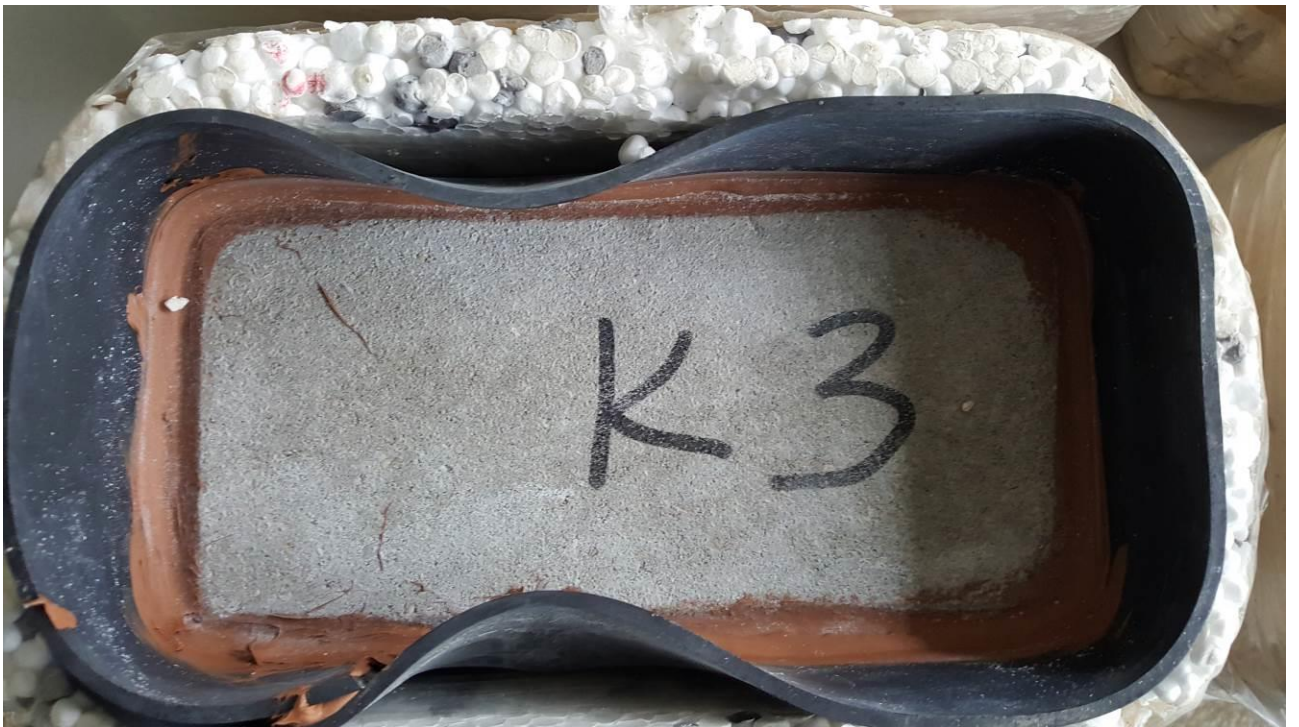
9 pav. K3 trinkelė prieš šaldymo bandymą (viršuje) ir po 72 parų bandymo (apačioje)
